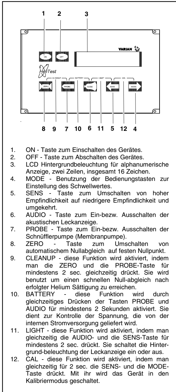
Vorderes Bedienfeld des HeliTest Rack 969-3581, 969-3582, 969-3580 und 969-3582
